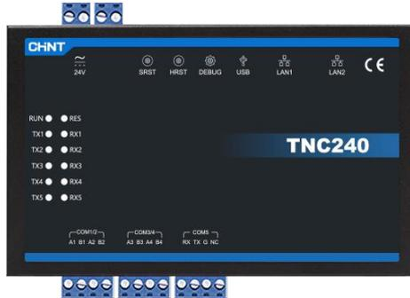
**TNC240**是我司完全自主研发的多功能网络控制器系列产品之一，支持以太网、RS485、RS232等多种通讯接口，并支持多种标准通讯协议，可实现BACnet MSTP/IP、Modbus RTU/TCP、MQTT等行业内主流协议的相互转化，可用于能源物联网、楼宇自控、智能照明、能耗采集等系统。
