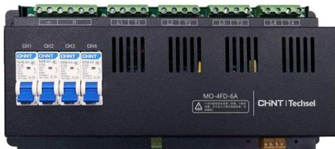
MO-4FD-6A是SMC系列调光模块产品之一，广泛应用于智能照明领域，具有4路6A前相沿可控硅调光输出功能，可接入阻性负载或白炽灯、卤素灯前沿相控电子变压器，配有220V前相沿可控硅调光驱动的LED灯。
