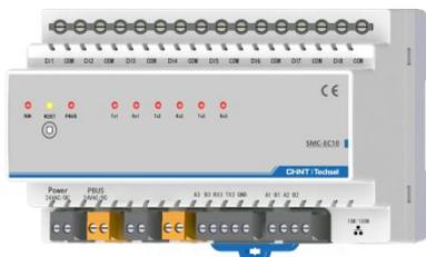
SMC-EC10是SMC系列智能网关产品之一,广泛应用于智能照明系统机电设备控制领域,具有1通道Pyxos总线(简称PBUS)、2通道RS485,1通道RS485/RS232,8通道光电隔离开关量输入功能;开关量输入可接入开关、报警、红外人体感应器等信号。
